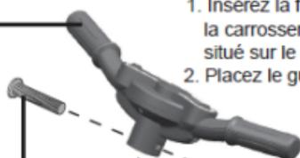
1. Insérez la fourche avant dans l'ouverture à l'avant de la carrosserie par le côté inférieur et à travers le trou situé sur le dessus du véhicule.
