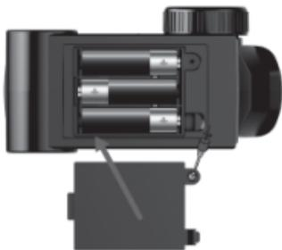
Retirez le cache des piles et insérez 3 piles AA.
