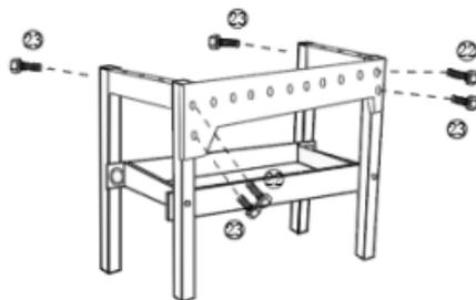
Note étape 1 : les vis sont a visser derrière le pied, et les boulons doivent se fixer à l'intérieur du pied.
